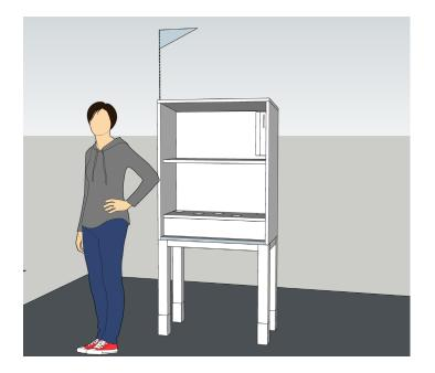
Tipp: Als Kasse haben wir rechts oben eine einfache abschließbare Kasse benutzt. Diese im Boden 4x durchbohrt und auf der Forderseite einen Schlitz eingeflext. Dann geöffnet und mit 4 Schrauben so in die Seitenwand geschraubt, daß der Schlitz nach vorne zur Käufer\*in zeigt. Dann zumachen und abschließen.
