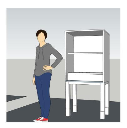
Dann das Dach aufsetzen und von oben mit den Seitenelementen und der Rückseite verschrauben. Auch hier, wie bei allen Bohrungen, hilft mit einem kleinen Bohrer vorbohren.
